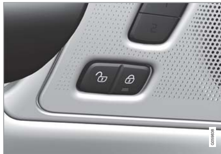
フロントドアのインジケーターランプ付きロックおよびロック解除ボタン
