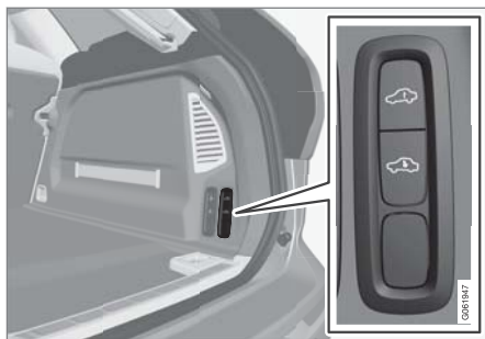
車両後部の上昇/下降用コントロールボタン
