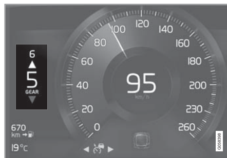
8 インチドライバーディスプレイのギヤシフトインジケーター
