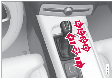
大型セレクトーレバーとギヤ位置の概観
