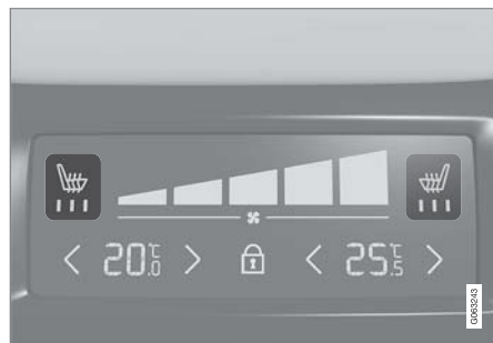
トンネルコンソール後部にあるクライメートパネルのシートヒーター表示およびコントロール
