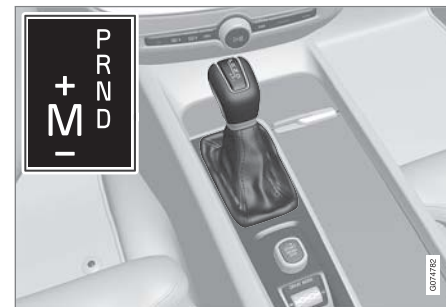
大型セレクトレーバーとドライバーディスプレイのシフトパターンの概観
