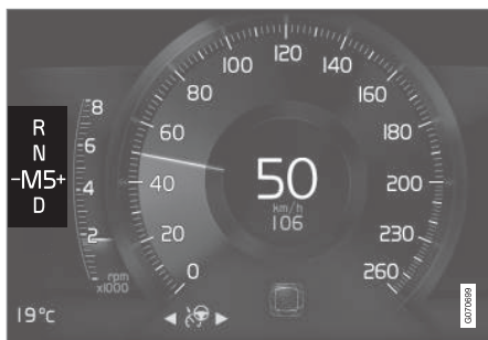
A fokozatváltás visszajelzése 8-hüvelyes járművezetői kijelzőn, kis sebességváltó karral.
