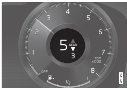
Fokozatváltás-jelző a 12-hüvelykes járművezetői kijelzőn*.
