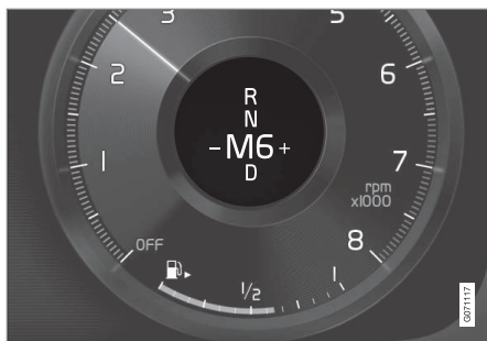
A fokozatváltás visszajelzése 12-hüvelyes járművezetői kijelzőn, kis sebességváltó karral*.
