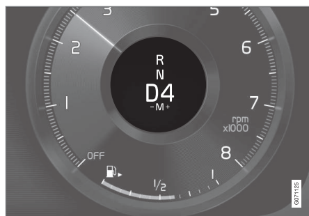
Járművezetői kijelző, amikor a kormányfülkekkel vált fokozatot, kis sebességváltó kar.
