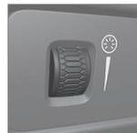
La molette du tableau de bord, à gauche du volant, permet de régler l'intensité lumineuse de l'écran, l'éclairage des commandes et l'éclairage d'ambiance\*
