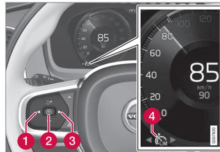
Le limiteur de vitesse n'est activé qu'au démarrage du moteur. Le réglage minimal de la vitesse maximale est 30 km/h (20 mph).
