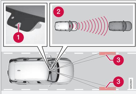
L'unité de caméra/radar mesure la distance au véhicule qui précède et détecte la signalisation au sol.
