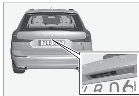
Le bouton gainé de caoutchouc sur le hayon ne peut servir qu'au déverrouillage.
