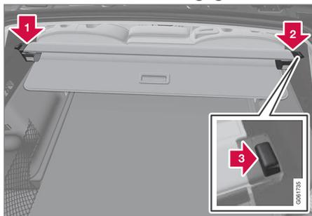
1. Placez l'une des extrémités du cache-bagages dans la fixation du panneau latéral du compartiment à bagages.
