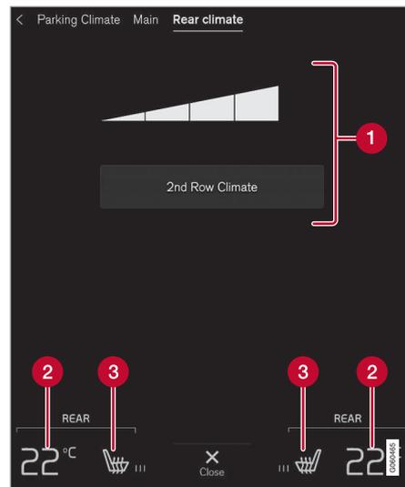
**1 Climatatisation de la deuxième rangée** - Commandes pour la climatisation de la banquette arrière. Commande de ventilateur de banquette arrière.
