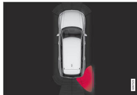
icône allumée pour Cross Traffic Alert sur le graphique **Assist. de stationnement semi-automatique** à l'écran.
