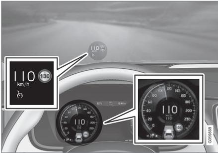
L'illustration précédente indique que le régulateur adaptatif de vitesse est réglé pour maintenir une vitesse de 110 km/h (68 mph) et qu'il n'y a aucun véhicule à suivre.
