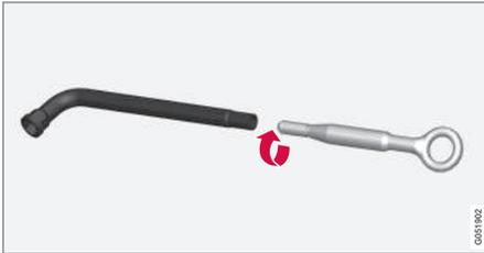
5. Démontez les capuchons en plastique des boulons de roue avec l'outil prévu.
