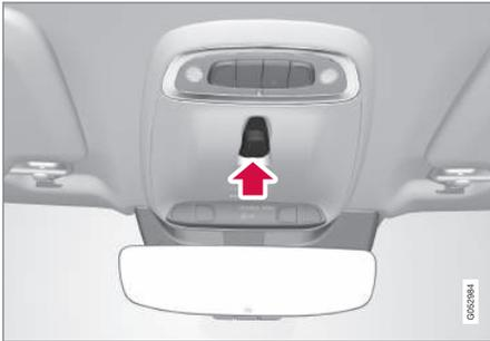
Le toit panoramique et son rideau pare-soleil sont manœuvrés par une commande placée dans le toit.
