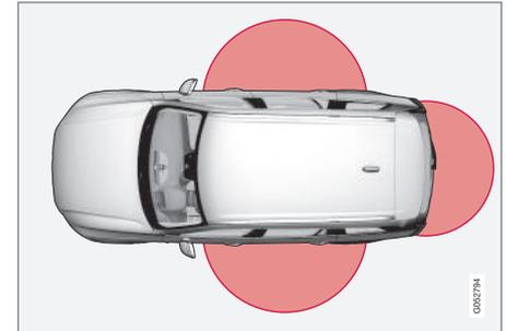
Les parties grisées sur l'illustration indiquent les zones couvertes par les antennes du système.
