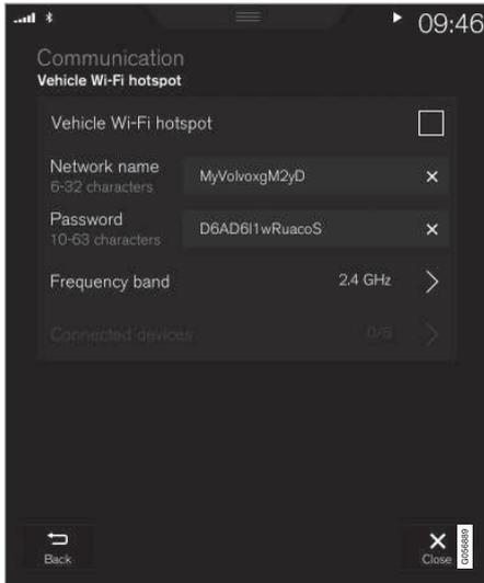
L'opérateur réseau (la carte SIM) doit permettre le partage de réseau (partage de connexion internet).
