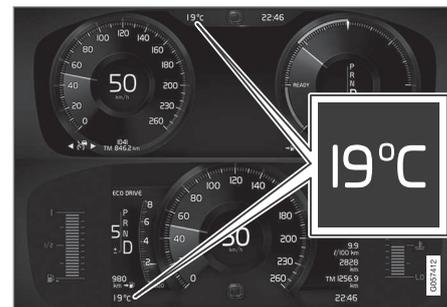
Emplacement de l'indicateur de température extérieure sur les écrans conducteur 12 pouces\* et 8 pouces. L'illustration est schématique, les détails peuvent varier selon le modèle de la voiture.
