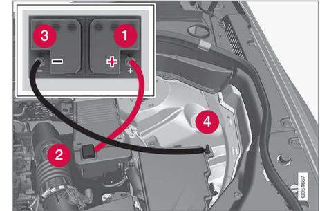
Points de fixation pour les câbles de démarrage. L'aspect du compartiment moteur peut varier selon le modèle de la voiture et le niveau d'équipement.
