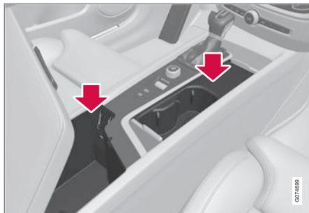
Compartiments de rangement avec porte-gobelets, chargeur sans fil de téléphone\*, prise électrique et port USB dans la console tunnel.
