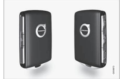
La télécommande comporte quatre boutons : un sur le côté gauche et trois sur le côté droit.
