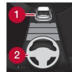
Ce n'est que lorsque le symbole de distance représente un véhicule (1) au-dessus du symbole en forme de volant que la distance temporelle au véhicule qui précède est régulée par Pilot Assist.
