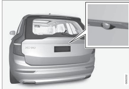
La caméra arrière est placée au-dessus de la plaque d'immatriculation.
