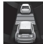
Ce n'est que lorsque le symbole de distance affiche deux véhicules que la distance temporelle avec le véhicule qui précède est ajustée par le régulateur adaptatif de vitesse. Un intervalle de
