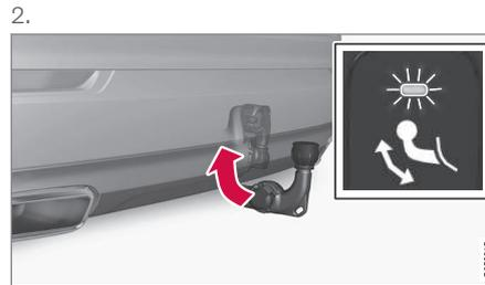
Verrouillez le crochet en le repoussant en position rentrée, où il se verrouillera.
