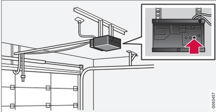
4. Cherchez le bouton d'apprentissage<sup>41</sup> sur le récepteur de la porte de garage par exemple. Il est généralement placé près de la fixation de l'antenne sur le récepteur.
