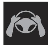
Si Pilot Assist détecte que les mains du conducteur ne sont pas sur le volant, le système avertit le conducteur par un symbole et un message à l'écran conducteur afin de l'encourager à conduire la
