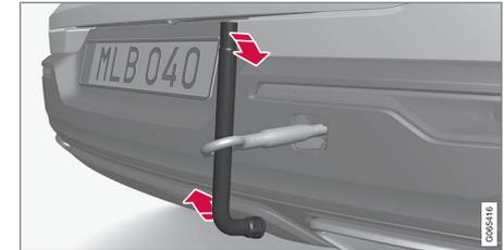
Vissez fermement l'œillet. Utilisez par exemple la clé à boulon de roue\* pour vous aider.
