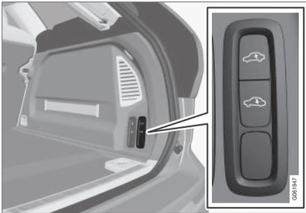
Utilisez les boutons dans le compartiment à bagages pour ajuster la hauteur de l'arrière de la voiture afin de faciliter le chargement et le déchargement ou pour atteler ou dételer une remorque.
