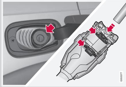
Il est essentiel d'insérer le bec du pistolet de pompe au-delà des deux clapets ouvrants du tuyau de remplissage avant de commencer le remplissage.
