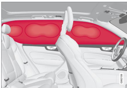
Le rideau gonflable est installé le long du plafonnier, des deux côtés et aide à protéger le conducteur et les passagers des places extérieures. Les panneaux sont marqués du symbole **IC AIRBAG**.
