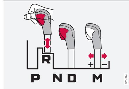
Blocage de sélecteur de vitesses des voitures équipées du gros levier de vitesses.
