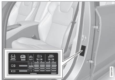
Emplacement de l'autocollant de pression des pneus
