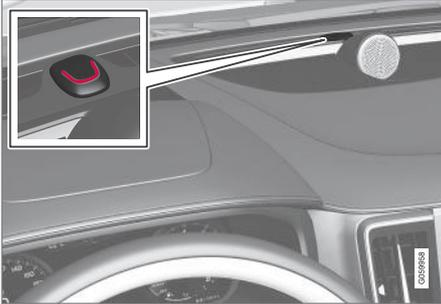
Le témoin de verrouillage et d'alarme indique le statut du système de verrouillage :
