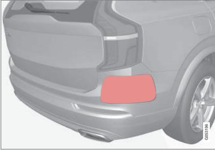
Emplacement des radars arrière. Maintenez la surface indiquée propre, des deux côtés de la voiture.
