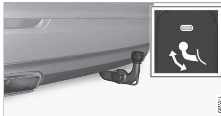
Poussez le crochet d'attelage en butée pour le fixer et le verrouiller. Le témoin reste allumé en orange.
