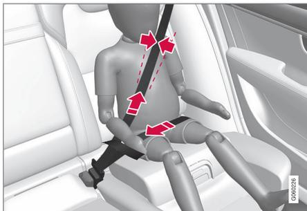
Placement correct, la ceinture doit être placée sur l'épaule.
