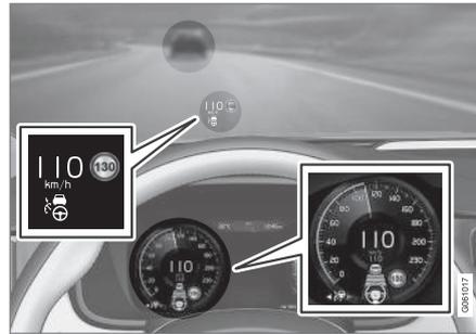
L'illustration précédente indique que Pilot Assist est réglé pour maintenir une vitesse de 110 km/h (68 mph) et qu'il suit un véhicule qui roule à la même vitesse.
