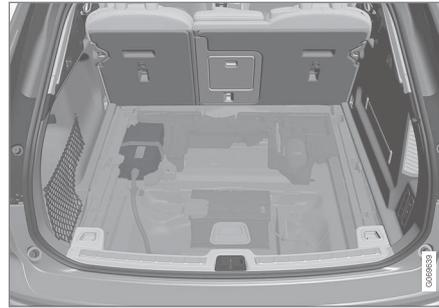
Si la voiture est équipée d'une batterie d'appoint 48 V, celle-ci se trouve sur la gauche du compartiment à bagages. La batterie d'appoint 48 V ne doit être manipulée que par un atelier agréé.
