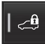
Le bouton de verrouillage privé se trouve dans la vue Fonctions de l'écran central. Selon l'état actuel du verrouillage, **Verr. voitureur déverrouillé** ou **Verrouillage voit. verrouillé** apparaît.
