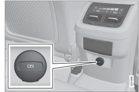
Ports USB (type C) à l'arrière de la console de tunnel pour le chargement d'un téléphone d'une tablette par exemple<sup>6</sup>.
