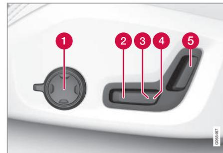
L'illustration montre les commandes sur une voiture à soutien lombaire quadridirectionnel\*. Les voitures à soutien lombaire bidirectionnel\* ne disposent pas de la commande multifonction tournante.
