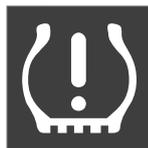
Contrôlez et corrigez la pression de gonflage lorsque le témoin de contrôle du système s'allume et que le message **Pression pneus faible** apparaît.
