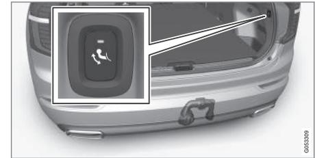
Ouvrez le hayon. Un bouton situé sur le côté droit à l'arrière dans le compartiment à bagages permet de sortir et de rentrer le crochet d'attelage. Un témoin sur le bouton doit s'allumer en orange pour permettre la sortie du crochet.
