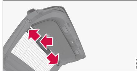
Retirez doucement le cache de l'un des fixations latérales du hayon puis de l'autre côté. Vous pouvez aussi appuyer légèrement sur le cache pour faciliter la dépose.
