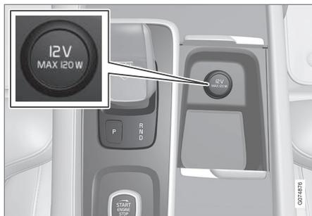
Prise électrique avant de console de tunnel pour voitures sans chargeur sans fil de téléphone\*.
