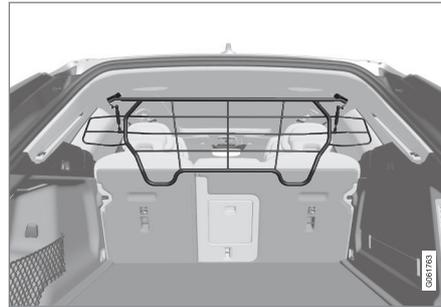
Pour des raisons de sécurité, la grille de protection doit toujours être fixée et accrochée correctement.
