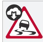
En cas d'alarme indiquant une chaussée glissante, ce symbole apparaît à l'écran conducteur lorsqu'un véhicule approche de la portion de route concernée, dans votre voiture et dans le véhicule qui a reçu l'information par l'intermédiaire de Connected Safety.
