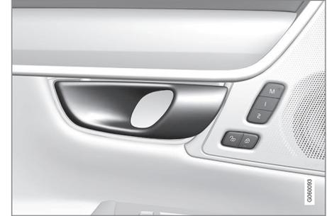
Poignée d'ouverture pour le déverrouillage alternatif d'une porte latérale<sup>12</sup>.
