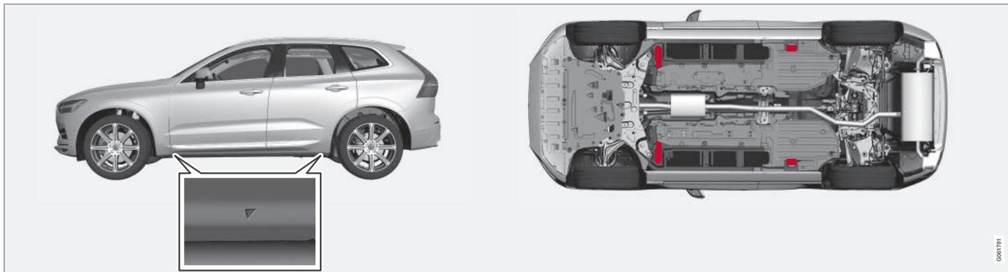
Les triangles du cache en plastique sont orientés vers l'emplacement des fixations du cric/points de levage (en rouge).
