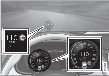
L'illustration précédente montre que le régulateur de vitesse adaptatif est réglé pour maintenir une vitesse de 110 km/h (68 mph) et qu'il n'existe pas de véhicule cible à l'avant à suivre.
