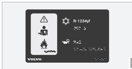
**6** **Autocollant de climatisation fluide frigorigène R1234yf.**
