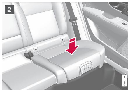
**2** Appuyer au centre du coussin rehausseur pour le verrouiller en position.
