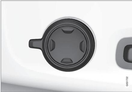
Commande multifonctions dans les voitures avec soutien lombaire à quatre directions\*.
