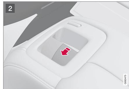
Pour les voitures sans siège rabattable électriquement, les appuie-têtes extérieurs sont rabattus manuellement à l'aide de la commande intérieure située sur la partie supérieure du siège ; voir la figure **2**.
