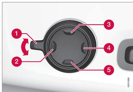
1. Activer la commande multifonction en faisant tourner la commande **1** vers le haut/le bas. La vue des réglages de siège s'affiche sur l'écran central.
