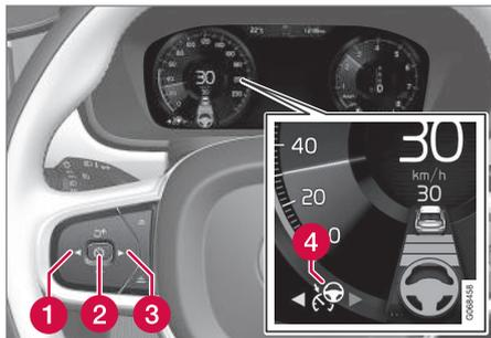
Le volant vert indique que Pilot Assist fournit une assistance sur la direction.
