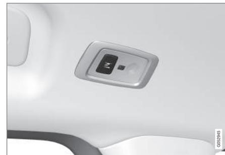
Dans les véhicules avec toit panoramique\*, il existe deux unités d'éclairage, à raison d'une unité de chaque côté du plafond.
