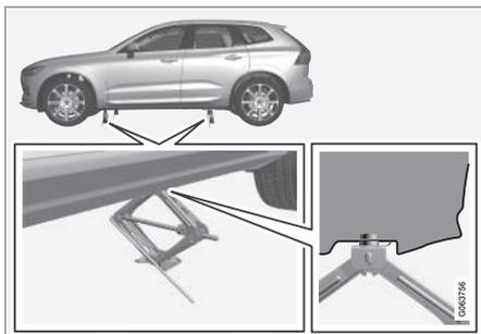
5. Placer le cric sous le point de fixation utilisé, en vérifiant si le sol est ferme, horizontal et non glissant.
