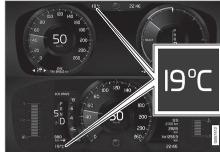
Emplacement du capteur de température ambiante dans le tableau de bord de 12 pouces\* et de 8 pouces. L'illustration est générique - les détails peuvent varier en fonction du modèle de véhicule.
