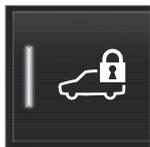
Le bouton de fonction pour le verrouillage privé se trouve dans la vue de fonction de l'affichage central. Selon l'état actuel du verrouillage, **Verr. indép. déverrouillé** ou **Verr. indép. verrouillé** s'affi-
