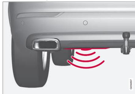
Le capteur se trouve à gauche du centre, sous le pare-chocs arrière<sup>17</sup>.
