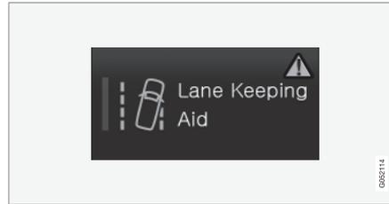
Un triangle d'avertissement dans la section du côté droit du bouton indique que quelque chose fonctionne mal.
