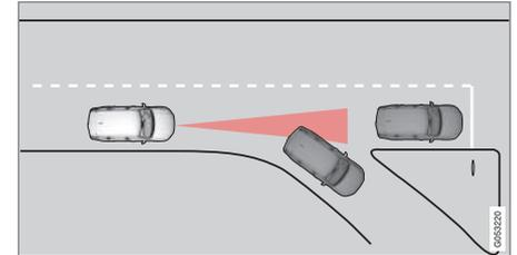
Si le véhicule cible à l'avant tourne brusquement, il peut exister une circulation arrêtée à l'avant.
