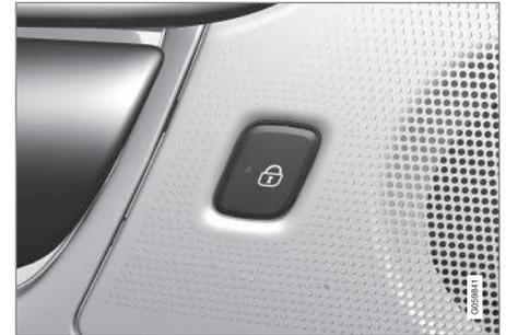
Boutons de verrouillage avec lampe indicatrice dans la porte arrière.
