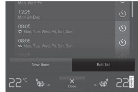
Le bouton d'édition d'une liste/suppression d'un paramètre du temporisateur dans l'onglet **Climatisation en stationnement** de la vue de climatisation.
