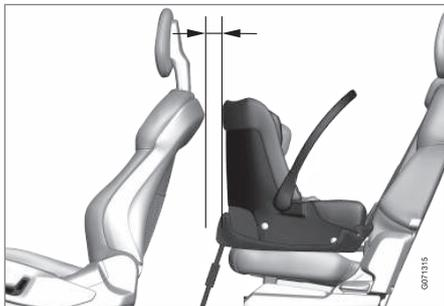
Pour l'installation d'un siège pour bébé dans le siège arrière, Volvo recommande de garder une distance d'au moins 50 mm (2 pouces) entre la partie avant du siège pour bébé et la partie la plus en arrière du siège devant.
