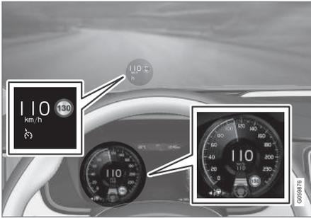
L'illustration précédente montre que Pilot Assist est réglée pour maintenir une vitesse de 110 km/h (68 mph) et qu'il n'existe pas de véhicule-cible à l'avant à suivre.
