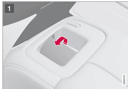
Pour les voitures équipées d'appuie-têtes rabattables à commande électronique\*, les appuie-têtes extérieurs peuvent être rabattus à l'aide des poignées situées sur la partie supérieure du siège, voir la figure **1**. Noter que cette méthode rabat également les dossiers. S'il ne faut rabattre que les appuie-têtes, pour améliorer la visibilité par exemple, il est possible de le faire depuis l'écran central au lieu de\*.
