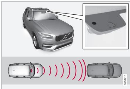
La caméra/le capteur radar mesurent la distance par rapport au véhicule qui précède.
