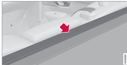
Le rabat avant doit être dirigé vers le bas, derrière le dossier, avant la mise en place de la cassette.
