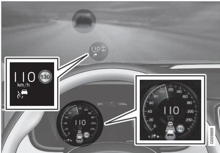
L'illustration précédente montre que le régulateur de vitesse adaptatif est réglé pour maintenir une vitesse de 110 km/h (68 mph) et qu'il
