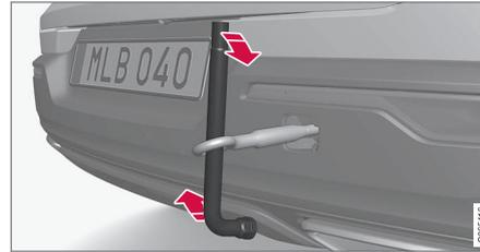
Fixer l'œillet par exemple en insérant une clé\* à travers lui et en l'utilisant comme levier.
