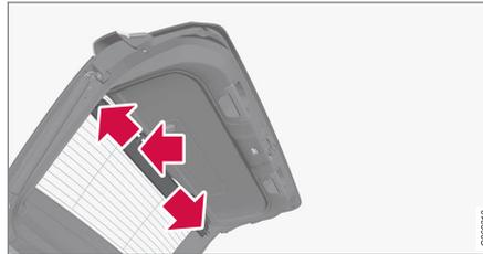
Extraire prudemment le rabat du support sur un côté du hayon puis de l'autre côté. Au besoin, presser légèrement ensemble le rabat pour le rendre plus souple et faciliter la dépose.
