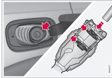
Il est important d'alimenter le gicleur de la pompe au-delà des deux crochets ouvrables du tuyau de remplissage avant de commencer le ravitaillement de la voiture.
