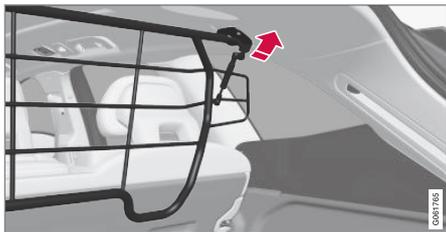
Placer les points de fixation de la grille dans les consoles du toit.
