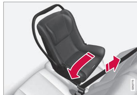
Acheminer la ceinture de sécurité à travers le siège pour nourrisson.
