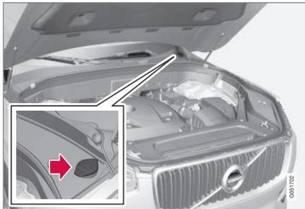
Le liquide lave-glace est versé dans le réservoir dont le bouchon est bleu. Le réservoir est utilisé pour le lave-glace de pare-brise, le lave-glace de vitre du hayon et le lave-phare\*
