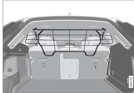
Pour des raisons de sécurité, la grille d'acier doit toujours être installée et fixée correctement.
