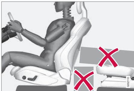
Ne placer aucun objet sur le sol derrière ou sous les sièges avant ni sur le siège arrière qui risque d'empêcher le fonctionnement de WHIPS.
