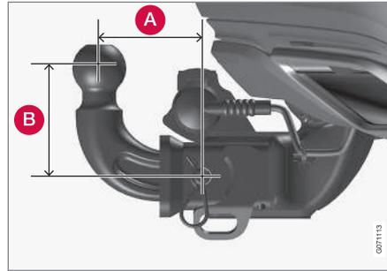
La boule de remorquage doit correspondre aux limites géométriques de la barre de remorquage, en termes de distance **A** et de hauteur **B**. Les limitations géométriques sont décrites sur la plaque signalétique située sur la barre de remorquage.
