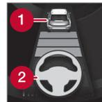
Pilot Assist régule uniquement l'intervalle de temps par rapport au véhicule qui précède lorsque le pictogramme de distance affiche un véhicule (1) par-dessus le pictogramme de volant de direction.
