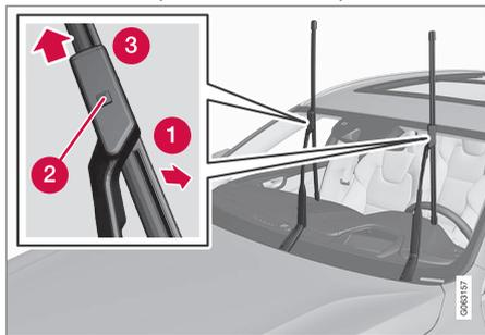
Lever les bras d'essuie-glace en position d'entretien. La position d'entretien est activée/désactivée via la vue de fonction dans l'affichage central lorsque la voiture est arrêtée et que l'essuie-glace du pare-brise ne fonctionne pas.
