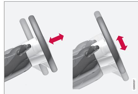
Le volant peut être réglé en hauteur et en profondeur.
