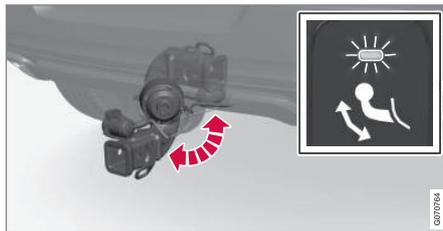
Fixer la barre de traction en place la repoussant à sa position rétractée sous le pare-chocs, où elle se verrouille en place.
