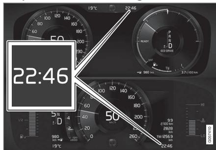
Emplacement de l'horloge dans les tableaux de bord de 12 po\* et de 8 po. L'illustration est générique - les détails peuvent varier en fonction du modèle de véhicule.
