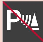
Une prudence supplémentaire est requise en reculant si ce pictogramme s'affiche lorsqu'une remorque, un support de vélo ou similaire est fixé(e) et connecté(e) électriquement au véhicule.
