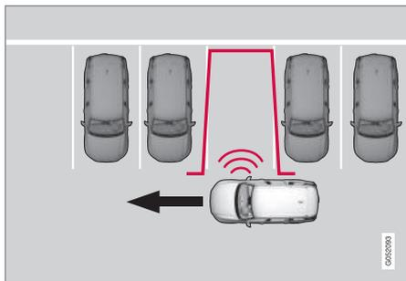
Procédure de recherche avant le stationnement perpendiculaire.
