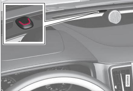
Le témoin de verrouillage et d'alarme affiche l'état du système de verrouillage :
