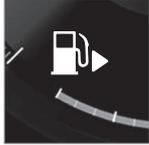
Dans l'écran du conducteur, une flèche à côté du symbole de pompe à carburant indique le côté du véhicule sur lequel se trouve le volet du réservoir de carburant.
