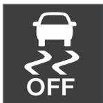
Lorsque **Mode Sport ESC** est activé, ce symbole s'allume d'une manière constante dans l'écran du conducteur. Il reste allumé jusqu'à ce que le conducteur désactive la fonction ou que le contact
