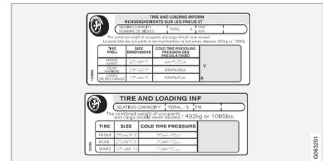
**3** Pressions de gonflage des pneus Cette étiquette indique les pressions de gonflage adéquates pour les pneus installés sur le véhicule au moment de quitter l'usine.
