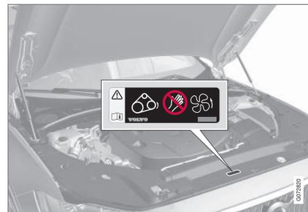
Emplacement de l'autocollant d'avertissement du compartiment moteur. La disposition du compartiment moteur peut varier en fonction du modèle et de la variante de moteur.
