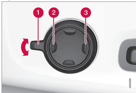
Bouton multifonction, situé sur le côté de la section de base du siège.
