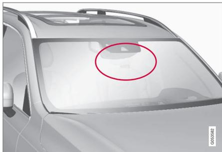
Emplacement du capteur radar
