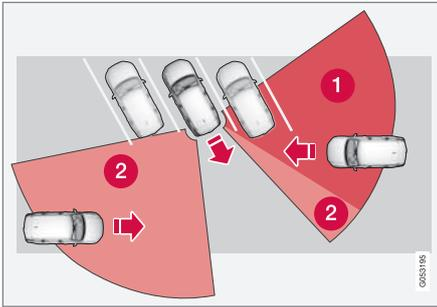
dans un espace de stationnement en diagonal, Cross Traffic Alert peut être complètement aveugle d'un côté de votre véhicule.
