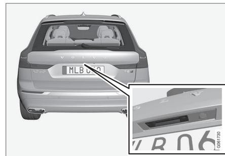
Le hayon est maintenu fermé par un mécanisme de verrouillage électrique.
