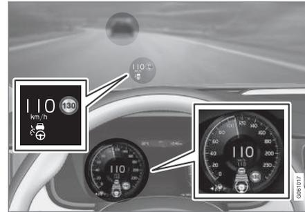
L'illustration précédente montre que Pilot Assist est réglée pour maintenir une vitesse de 110 km/h (68 mph) et suit un véhicule cible à l'avant, qui circule à la même vitesse.
