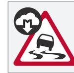
Si une alerte de verglas se déclenche, ce symbole s'affiche sur l'écran du conducteur quand un véhicule s'approche de la section de route glissante, à la fois dans votre voiture et dans d'autres véhicules qui ont reçu les informations par Connected Safety.
