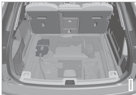
Si la voiture est équipée d'une batterie d'appoint de 48 V, elle est située à gauche dans le compartiment à bagages. La batterie d'appoint de 48 V ne doit être manipulée que par un atelier agréé.
