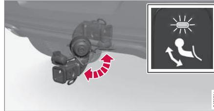
> La barre de traction se déplie et s'abaisse en position déverrouillée - la lampe indicatrice clignote en orange. Le crochet d'attelage est prêt à continuer à se déployer en position verrouillée.
