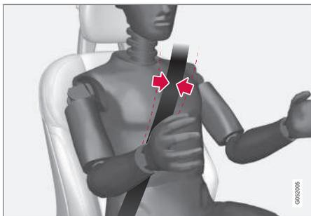
La ceinture de sécurité doit passer au-dessus de l'épaule (et non pas par le bas au-dessus du bras).
