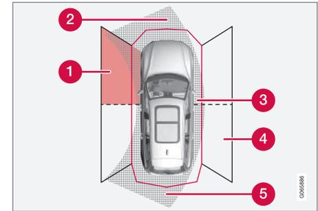
Secteurs des capteurs d'aide au stationnement où les obstacles peuvent être détectés.
