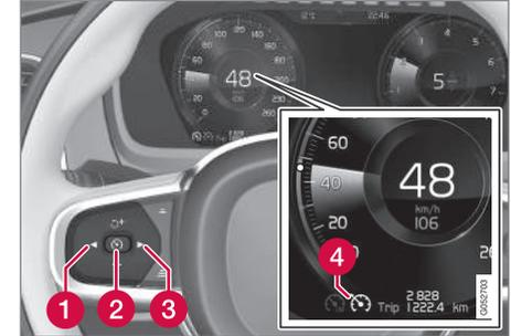
Pour lancer le régulateur de vitesse à partir du mode attente, la vitesse actuelle du véhicule doit être de 30 km/h (20 mph) ou plus.
