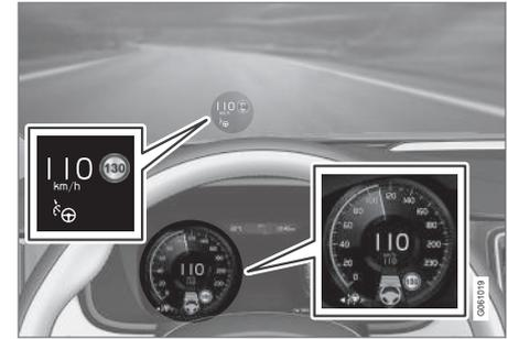
L'illustration précédente montre que Pilot Assist est réglée pour maintenir une vitesse de 110 km/h (68 mph) et qu'il n'existe pas de véhicule-cible à l'avant à suivre.
