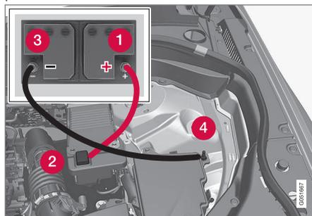
Points de raccordement du câble volant. L'aspect à l'intérieur du compartiment moteur peut varier selon le modèle de la voiture et le niveau d'équipement.
