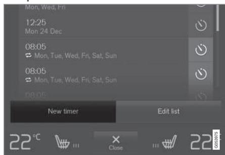
Bouton pour l'ajout d'un réglage de temporisateur dans l'onglet **Climatisation en stationnement** de la vue de climatisation.
