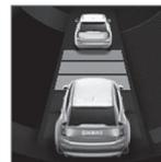
L'intervalle de temps est régulé uniquement par rapport au véhicule qui précède par le régulateur de vitesse automatique lorsque le pictogramme de distance affiche deux véhicules. Un intervalle de vitesse est marqué au même moment.
