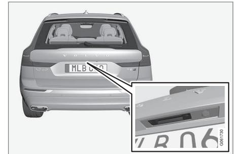
La plaque de pression caoutchoutée du hayon peut être utilisée pour le déverrouillage.
