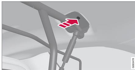
Visser la vis prévue en place en utilisant la clé Allen prévue de 6 mm. Répéter l'opération de l'autre côté. Couple recommandé : 20 Nm (15 lb-pi)
