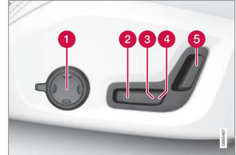
L'illustration montre les commandes d'une voiture équipée du soutien lombaire à quatre directions\*. Les voitures équipées d'un soutien lombaire à deux directions\* ne disposent pas de la commande multifonction rotative.
