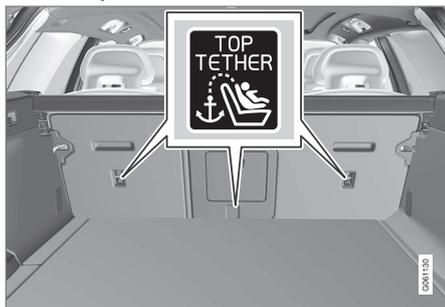
Ancrages d'attache supérieurs et symboles sur la face arrière des dossiers de sièges arrière. Il n'existe aucun symbole pour les ancrages d'attache centraux.
