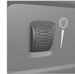
La molette du tableau de bord à gauche du volant de direction permet de régler la luminosité de l'éclairage de l'écran, l'éclairage des commandes, l'éclairage décoratif ambiant et l'éclairage d'am-
