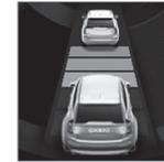
Les différents intervalles de temps par rapport au véhicule qui précède peuvent être sélectionnés et s'afficher au tableau de bord sous la forme de 1 à 5 barres horizontales.
