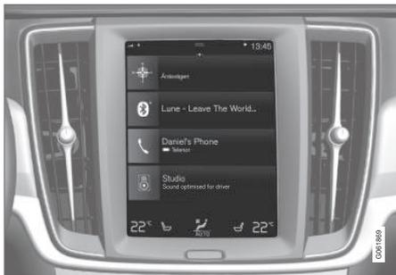
De nombreuses fonctions principales du véhicule sont commandées depuis l'écran central, un écran tactile qui réagit aux effleurements et autres gestes. Ceci minimise le nombre de boutons et commandes physiques nécessaires dans le véhicule. L'écran peut également être utilisé en portant des gants.
