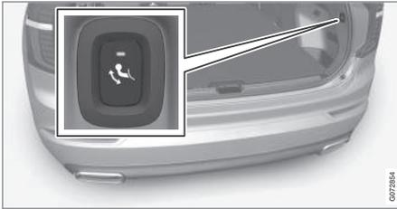
Ouvrir le hayon. Un bouton de commande de la barre d'attelage se trouve sur le côté droit à l'arrière du compartiment à bagages. L'éclairage orange continu de la lampe indicatrice du bouton montre que la fonction de rabattement est active.
