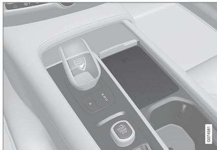
Chargeur de téléphone sans fil dans la console de tunnel.
