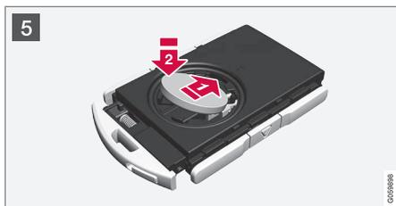
5 Insérer une nouvelle pile avec le côté positif (+) dirigé vers le haut. Ne pas toucher les surfaces de contact de la pile de la clé de commande à distance.
