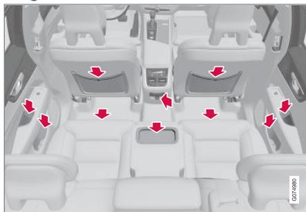
Compartiment de rangement dans le panneau de porte, les porte-gobelets\* dans le dossier de siège central, pochette de rangement\* dans le dossier de siège avant, port USB dans la console centrale et compartiment de rangement sous le siège.
