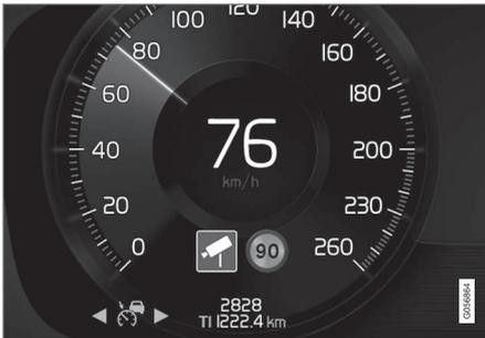
Exemples d'information sur la présence de radar et de limite de vitesse affichée dans l'écran du conducteur
