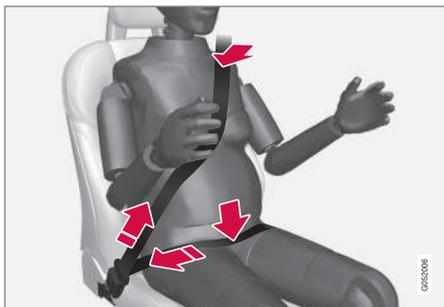
La ceinture de sécurité doit s'ajuster étroitement contre l'épaule, avec la section diagonale entre les seins et vers le côté de l'estomac.
