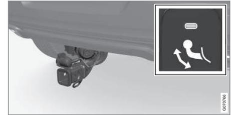
Déplacer la barre de traction à sa position finale, où elle se verrouille en place - la lampe indicatrice reste allumée en orange.
