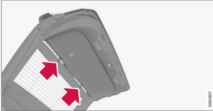
Presser les deux agrafes supérieures dans les évidements respectifs du hayon jusqu'au déclic de la mise en place.
