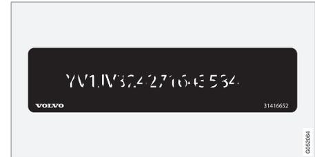
**2** Numéro d'identification du véhicule (NIV). La plaque du NIV est située sur la surface supérieure gauche du tableau de bord. Le numéro d'identification du véhicule (NIV) doit toujours être mentionné lorsque vous communiquez avec le concessionnaire concernant le véhicule ou lorsque vous commandez des pièces.
