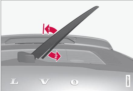
Lever le bras d'essuie-glace du pare-brise et tirer la section inférieure du balai vers la droite.
