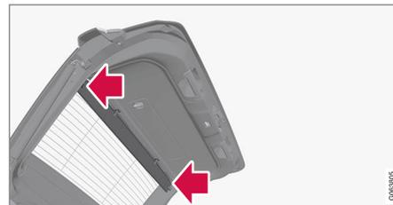
Faire tourner le rabat de manière à ce que le côté vis soit dirigé vers le bas et guider la goupille dans le support sur un côté du hayon.
