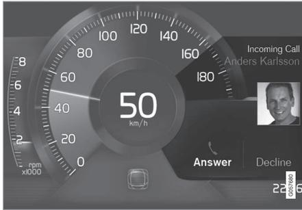
Exemple de message dans l'écran du conducteur de 8 pouces. L'illustration est générique - les détails peuvent varier en fonction du modèle de véhicule.
