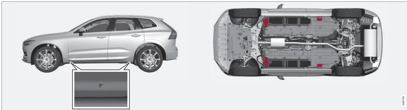
Les triangles dans le recouvrement de plastique indiquent l'emplacement des points de fixation de cric/points de levage (zones rouges).
