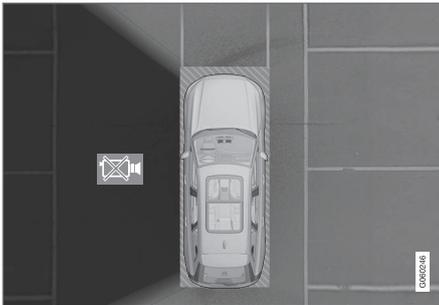
La caméra du côté gauche du véhicule est en panne.
