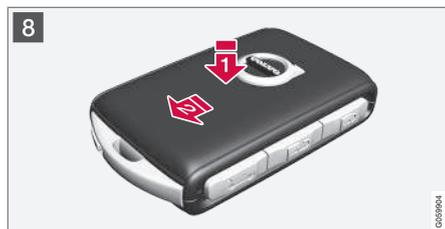
8 **1** Faire tourner la clé de commande à distance par-dessus et enfoncer le couvercle avant jusqu'au déclic.
