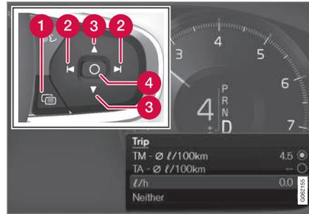
Ouvrir le menu d'application<sup>2</sup> et y naviguer en utilisant le clavier placé à droite du volant de direction.
