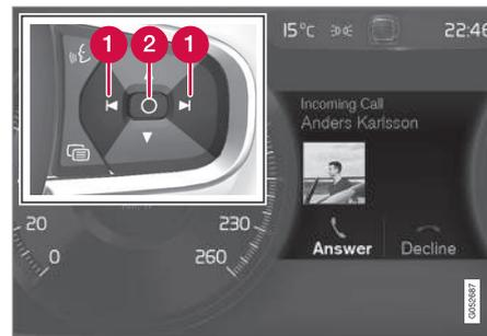
Exemples de messages du tableau de bord<sup>5</sup> et clavier placé à droite du volant de direction. L'illustration est générique - les détails peuvent varier en fonction du modèle de véhicule.
