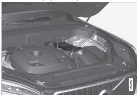
12 V varuaku asub amordipüstaku kõrval olevas kassis.
