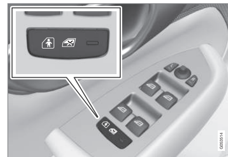
Botón de conexión y desconexión.
