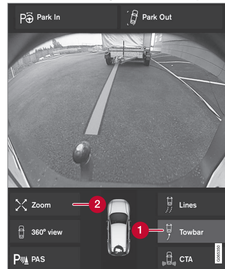
Enganche de remolque con línea auxiliar
