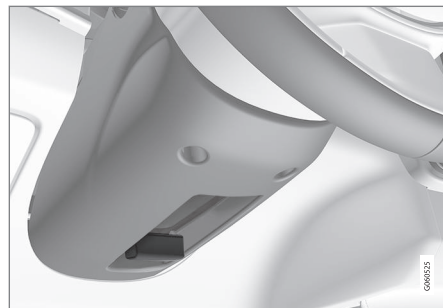
Palanca de regulación del volante.
