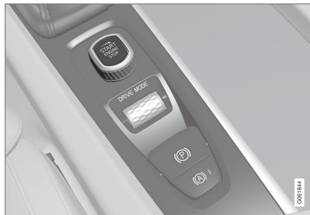
Startknappen i tunnelkonsollen.
