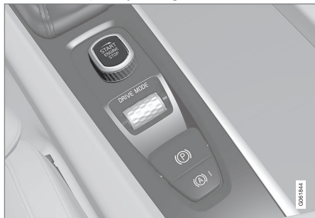
Startknappen i tunnelkonsollen.
