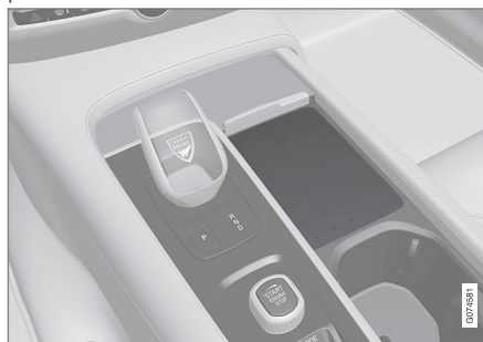
Bezdrátová nabíječka telefonu v tunelové konzole.
