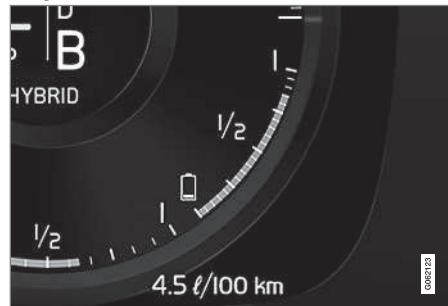
L'energia nella batteria ibrida è utilizzata per il motore elettrico nonché per raffrescare o riscaldare l'automobile. Il computer di bordo calcola un'autonomia indicativa in base all'energia nella batteria ibrida.
