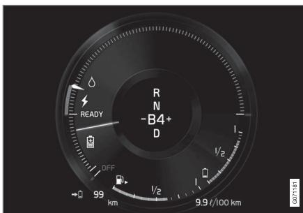
Il display del conducente indica la ricarica con il freno motore elettrico.
