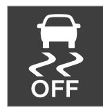
L'attivazione della **Modalità Sport ESC** è segnalata sul display del conducente da questo simbolo, che rimane acceso con luce fissa finché la funzione non è disattivata o fino allo spegnimento del motore. Al successivo riavvio, il sistema è di nuovo in modalità normale.
