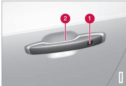
**1** Rientranza sensibile per il bloccaggio
