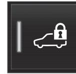
Il pulsante della funzione bloccaggio privato è disponibile nella videata funzioni sul display centrale. A seconda dello stato attuale di bloccaggio viene visualizzato **Serratura sbloccata** o
