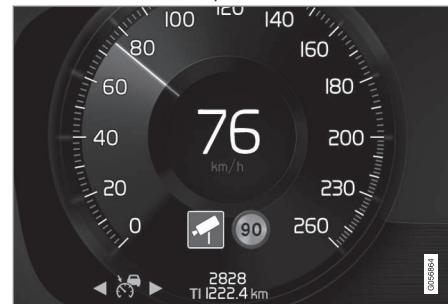
Esempio di informazioni su autovelox e limiti di velocità sul display del conducente
