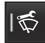
Premere il pulsante **Pos. servizio tergilicristalli**. L'indicatore luminoso nel pulsante si accende quando si attiva la posizione di assistenza. All'attivazione, i tergilicristalli si portano in posizione di assistenza. Per disattivare la posizione di assistenza, premere nuovamente **Pos. servizio tergilicristalli**. L'indicatore luminoso nel pulsante si spegne quando si disattiva la posizione di assistenza.
