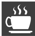
Se l'automobile continua a procedere a zigzag, il conducente viene avvertito con questo simbolo sul display del conducente combinato con un segnale acustico e il messaggio **È il momento di fare una pausa.**
