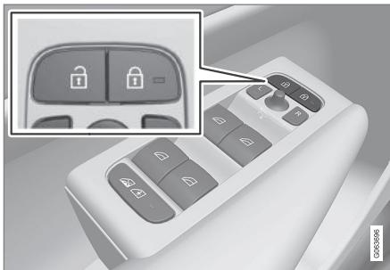
Pulsante di bloccaggio e sbloccaggio nella portiera anteriore con spia.
