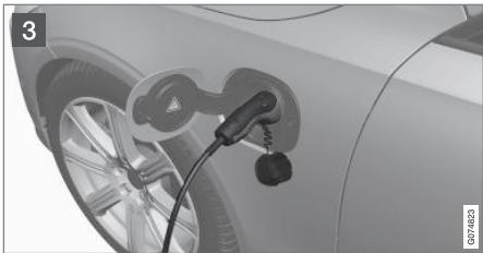
3 Fissare il coperchio protettivo dell'impugnatura di ricarica come mostrato in figura.
