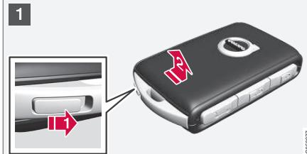
**1** Tenere la chiave telecomando con il lato anteriore ben in vista e il logotipo Volvo orientato correttamente. Spingere verso destra il pulsante presso l'anello portachiavi sul bordo inferiore. Fare scorrere il guscio del lato anteriore verso l'alto di alcuni millimetri.
