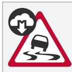
In caso di allarme per fondo stradale scivoloso, viene visualizzato questo simbolo sul display del conducente quando un veicolo si avvicina al tratto scivoloso, sia nella propria automobile che nel veicolo che ha ricevuto l'informazione tramite Connected Safety.
