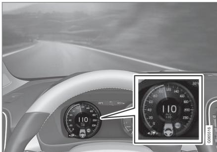
La figura precedente mostra che il Pilot Assist è impostato per mantenere una velocità di 110 km/h (68 mph) e che non è presente un veicolo antistante da seguire.
