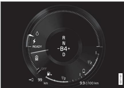
L'automobile genera corrente per la batteria che si ricarica, ad esempio, con una leggera pressione del pedale del freno oppure utilizzando il freno motore in discesa.
