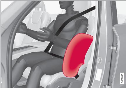
Gli airbag laterali sono montati sui lati esterni degli schienali dei sedili anteriori ed assistono a proteggere il conducente ed il passeggero del sedile anteriore.
