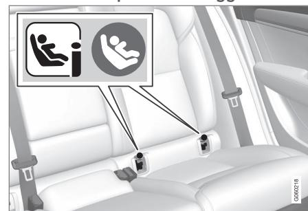
La posizione dei punti di fissaggio è indicata da simboli<sup>2</sup> sul rivestimento dello schienale.
