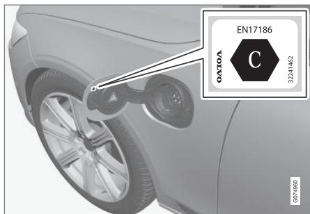
Utilizzare un tipo di ricarica approvato per l'automobile, vedere l'identificatore<sup>1</sup> all'interno dello sportello della presa di ricarica.
