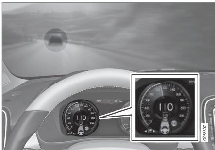
La figura precedente mostra che il Pilot Assist è impostato per mantenere una velocità di 110 km/h (68 mph) e segue un veicolo antistante che mantiene la stessa velocità.
