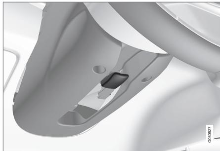
Leva per la regolazione del volante.
