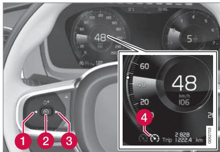
Per avviare il regolatore elettronico della velocità dal modo di attesa è necessario che l'automobile proceda ad almeno 30 km/h (20 mph).
