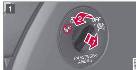
**1** Estrarre il commutatore e ruotarlo da **OFF** a **ON**.
