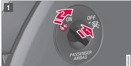
1 Estrarre il commutatore e ruotarlo da **ON** a **OFF**.
