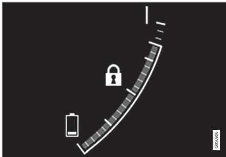
Il simbolo nel misuratore della batteria ibrida indica che è attivata la funzione Hold e il simbolo indica che è attivata la funzione Charge.
