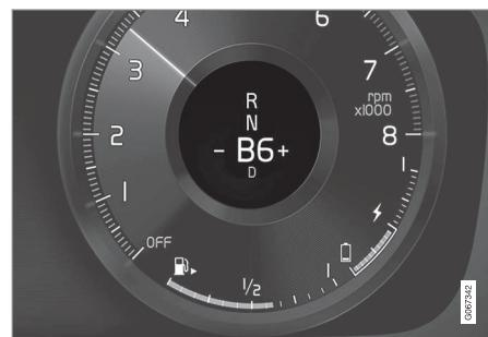
Indicatore di cambio marce nel display del conducente<sup>5</sup>.
