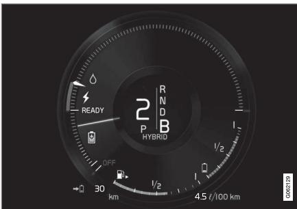
Indicazione sul display del conducente di recupero dell'energia
