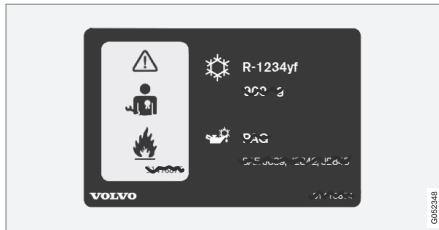
**2** Etichetta sulle automobili dotate di climatizzatore contenente refrigerante R1234yf.
