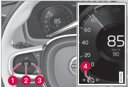
Il limitatore di velocità può essere attivato solo a motore acceso. La velocità max memorizzabile deve essere superiore a 30 km/h (20 mph).
