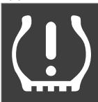
Effettuare i necessari controlli e ripristinare la pressione dei pneumatici quando si accende il simbolo di controllo del sistema e viene visualizzato il messaggio **Bassa press. pneum..**
