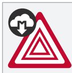
Quando l'automobile si avvicina a un veicolo con i lampeggiatori di emergenza accesi, viene visualizzato questo simbolo sul display del conducente.
