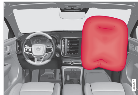
Airbag en el asiento delantero del acompañante.
