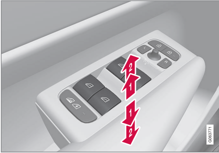
Accionamiento de los elevalunas eléctricos.
