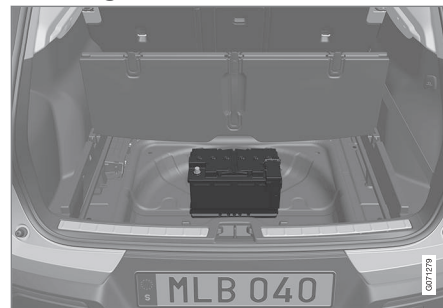
Startbatteriet er placeret i bagagerummet.
