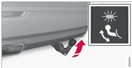
> 拖車桿向外並向下伸出於未鎖定位置 - 指示燈閃爍橘光。拖鉤已準備好繼續移動到鎖定位置。
