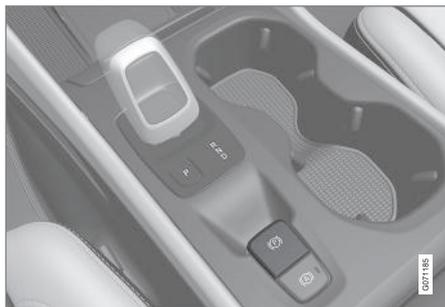
使用電控手煞車時，可聽見一微弱的電動馬達聲響。在駐車煞車自動功能檢查也可聽見這個聲音。
