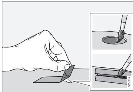
若損傷尚未深達金屬，可在將表面清理乾淨後直接補漆。
