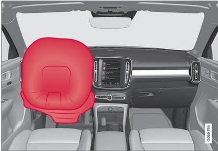
前座駕駛側的方向盤防護氣囊及膝部防護氣囊<sup>1</sup>。
