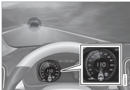
上圖顯示 Pilot Assist 設定為保持 110 km/h (68 mph)，同時跟隨保持相同速度的前車。
