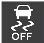
駕駛人顯示器上會以此恆亮符號顯示 ESC 運動模式啟用，直到此功能停用或引擎關閉為止。引擎下次起動後，系統會再度回到正常模式。
