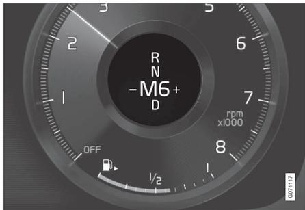
駕駛人顯示器中的換檔指示器顯示目前檔位，並且會在建議換至較高檔位時閃動加號。
