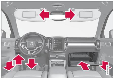
車門面板儲物空間、方向盤左側卡片夾、駕駛座下方存放格<sup>1</sup>、遮陽板及附有延伸鉤的手套箱。
