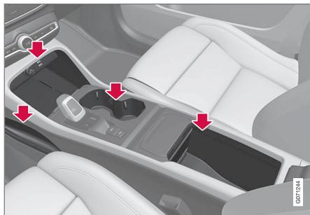
置腳處儲物空間、無線手機充電器上方的電源插座及 USB 埠\*、杯架和前座中央扶手下方的置物格。
