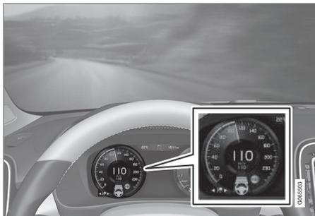
上圖顯示 Pilot Assist 設定為保持 110 km/h(68 mph)，而且沒有前車可跟隨。
