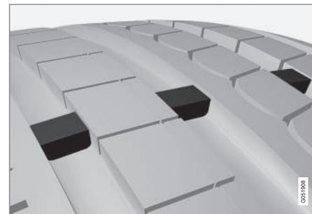
胎紋磨耗指示是一道跨越輪胎胎紋圖形縱向溝槽的凸起細線。輪胎側邊寫著字母 TWI (Tread Wear Indicator)。當輪胎胎紋深度磨耗到 1.6 公釐 (1/16 吋) 時，胎紋就會與胎紋磨耗指示齊平。此時應盡快更換新輪胎。請記住，當輪胎胎紋變淺時，其行駛於雨中與雪中的抓地力會相當差。
