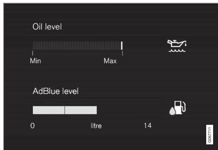
中央顯示器上的 AdBlue 液位圖形。
