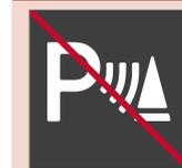
若車輛加掛拖車、自行車架或類似裝備，且拖車與車輛電性連接，則在倒車時看見此符號顯示必須特別留意。
