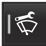
壓下設定擋風玻璃 雨刷維修模式按鈕。當保養模式啟用時，按鈕中的指示燈會亮起。啟用時，雨刷會移至保養位置。要停用保養模式，請再次按下設定擋風玻璃 雨刷維修模式。當保養模式關閉時，按鈕中的指示燈會熄滅。
