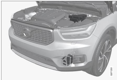
12 V 支援電瓶位於引擎室底下。發動電瓶也顯示在此(頂部)。
