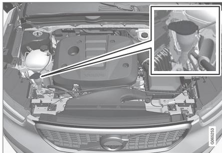
清洗液是填充進附有藍色蓋子的貯液筒中。此貯液筒用於擋風玻璃沖洗器、後窗沖洗器及頭燈沖洗器\*
