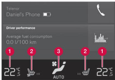
具兩區恆溫設定的恆溫控制列。具單區恆溫設定的恆溫控制列的控制裝置位置有些不同。
