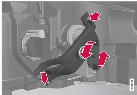
3. 逆時針轉鬆並拆除彈簧螺栓，將夾扣壓入側邊，然後拆除支撐橋。將螺絲留在支撐橋內以便操作。
