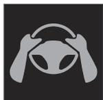
若 Pilot Assist 偵測到駕駛人並未將雙手放在方向盤上，系統會以駕駛人顯示器中的燈號和文字訊息示警，提醒駕駛人主動操控車輛。
