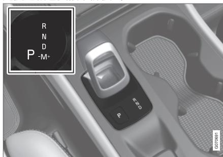
排檔桿和駕駛人顯示器中的換檔模式概覽。
