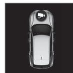
中央顯示器車輛符號上的相機符號顯示現在作用的是哪幾台攝影機。
