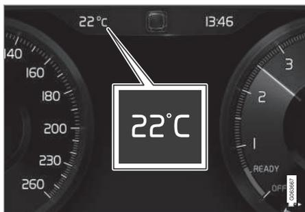
汽車停止不動時，車外溫度計顯示的溫度可能會高於實際溫度。
