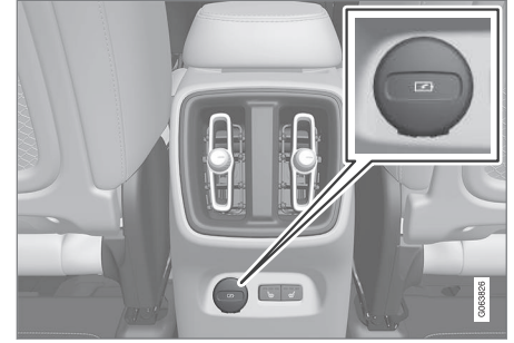
Örneğin tünel konsolunun arkasındaki USB girişleri* (tip C) telefonların ve tabletlerin şarj edilmesi içindir 6 .
