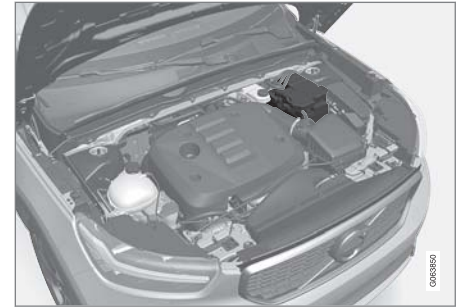
แบตเตอรี่สตาร์ทติดตั้งอยู่ในห้องเครื่องยนต์
