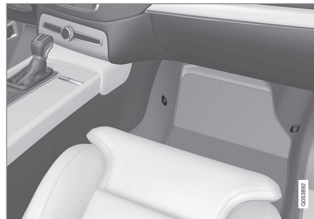
Mesta pritrdilnih točk na sprednjem sedežu.
