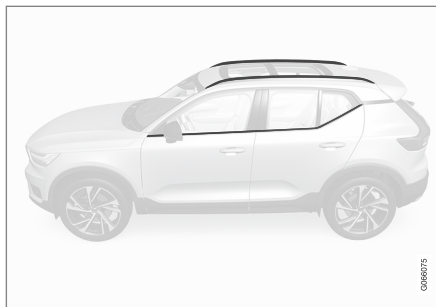
Componente care trebuie spălate cu un agent de curățat cu un pH cuprins între 3,5 și 11,5.
