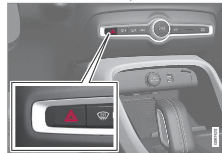
Buton pentru luminile de avarie.
