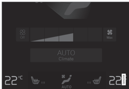
Botões de temperatura na linha da climatização. 6
