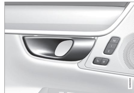
Puxador de abertura para destravamento alternativa da porta lateral 12 .
