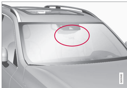
Localização da unidade do radar
