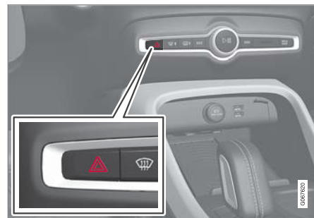
非常点滅灯ボタン
