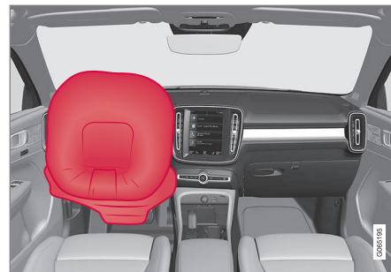
Airbag nel volante e airbag ginocchia 1 nel sedile anteriore sul lato conducente.
