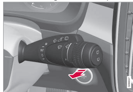
Fonction lave-glace, levier droit au volant
