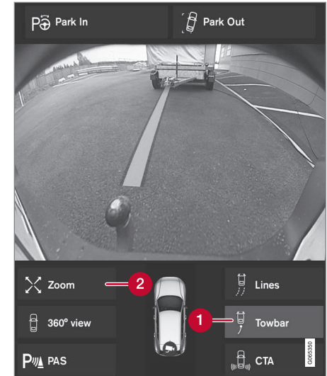
Crochet d'attelage avec ligne indicatrice
