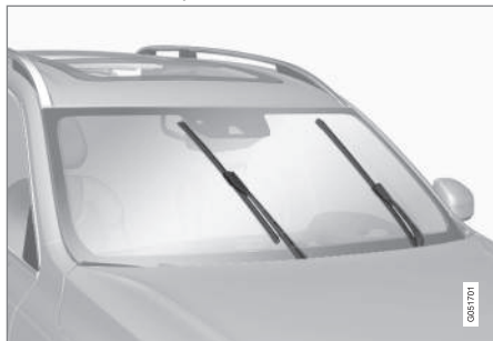
Balais d'essuie-glace en position d'entretien.
