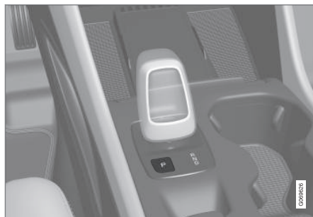
Vue d'ensemble du levier de vitesse et de la position P
