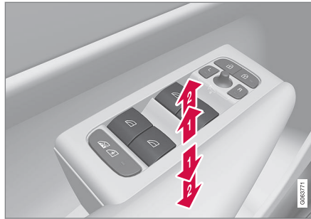
Fonctionnement des vitres électriques.
