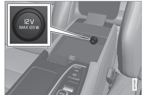
Električna vtičnica 12 V v talni konzoli, sprednji sedež.
