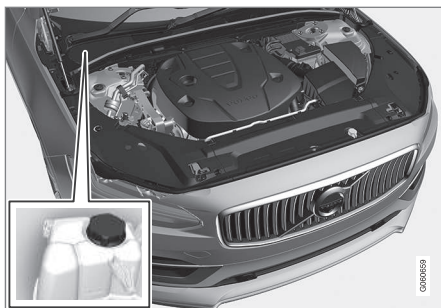
Serbatoio di espansione dell'impianto di raffreddamento, automobile con guida a destra
