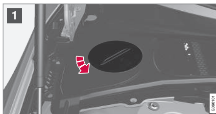
Hűtőfolyadék tágulási tartálya, balkormányos autó
