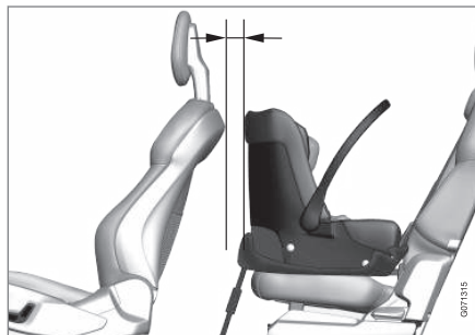
Babaülés hátsó ülésre szerelve. A Volvo azt ajánlja, hogy legalább 50 mm (2 hüvelyk) távolságot javasol a babaülés első része és az első ülés hátsó része között.
