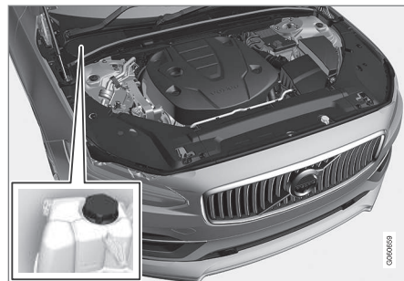
Hűtőfolyadék tágulási tartálya, jobbkormányos autó
