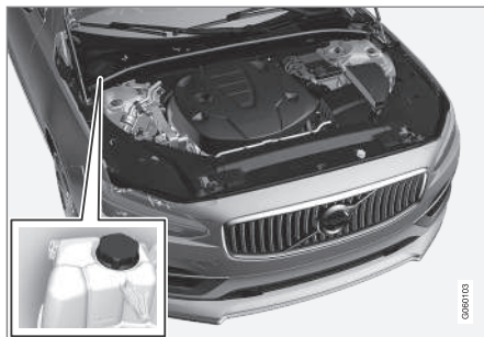
Hűtőfolyadék tágulási tartálya, balkormányos autó
