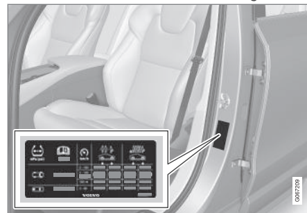
A gumiabroncsnyomás címke elhelyezkedése
