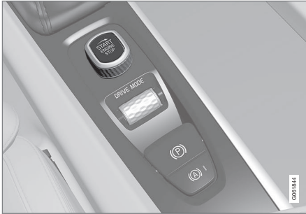
Startvredet i tunnelkonsolen.
