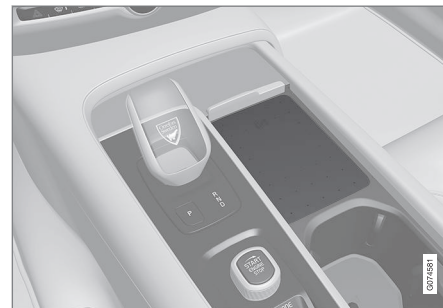
Trådlös telefonladdare i tunnelkonsolen.
