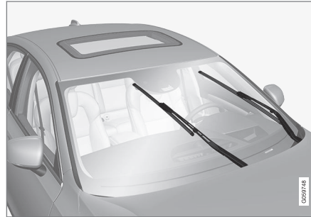
Torkarblad i serviceläge.
