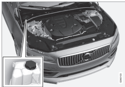
Expansionskärl för kylsystem, vänsterstyrd bil
