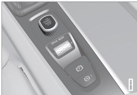
Startvredet i tunnelkonsolen.
