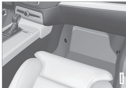
Locațiile punctelor de fixare pe scaunul față.
