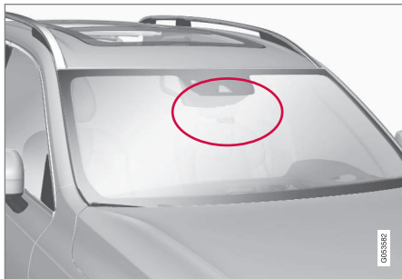
A kamera egység elhelyezkedése
