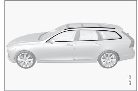
Alkatrészek, amelyek 3,5 és 11,5 pH-érték közötti tisztítószerrel moshatók.
