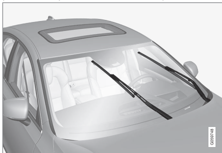
Balais d'essuie-glaces en position d'entretien.
