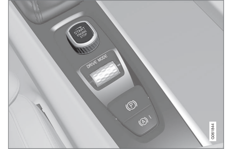
Käynnistyskytkin tunnelikonso- lissa.
