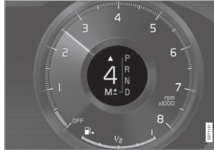
Vaihtamisosoitin 12-tuumaisessa kuljettajan näytössä koskien isoa vaihdevipua*.
