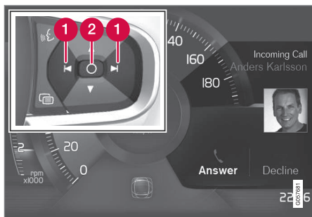
Примери за съобщения на дисплея на водача 4 и дясната клавиатура на волана.
