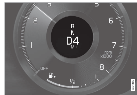
Дисплей на водача при смяна на предавки с лопатките на волана, малък скоростен лост.
