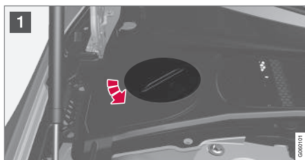
Разширителен резервоар за охлаждайна течност, автомобил с ляв волан
