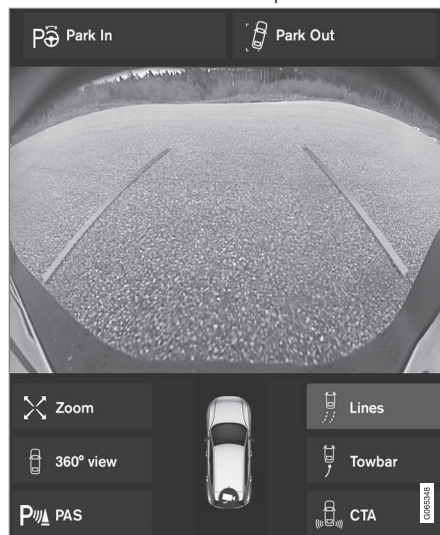
Пример за линии за помощ при паркиране
