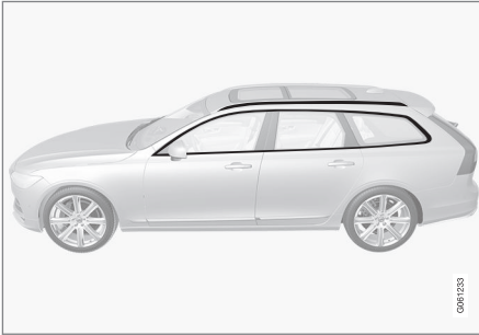
Части, които трябва да се измиват с почистващо средство с pH между 3,5 и 11,5.
