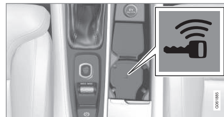
Местоположение на резервен четец в тунелната конзола.
