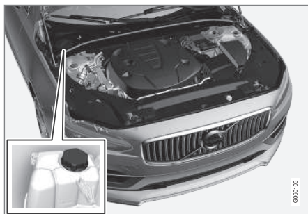
Разширителен резервоар за охлаждайна течност, автомобил с ляв волан
