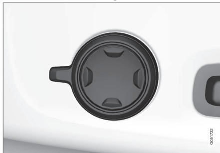
Multifunktionsreglaget, placerad på sidan av sätets sittdel.
