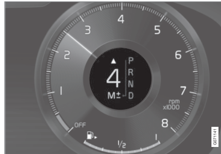
Växlingsindikator i 12-tums förardisplay för stor växelspak*.
