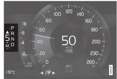
Växlingsindikator i 8-tums förardisplay för stor växelspak.
