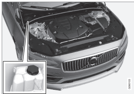
Expansionskärl för kylsystem, vänsterstyrd bil
