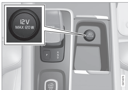
Predná elektrická zásuvka na stredovom tuneli pre vozidlá bez bezdrôtovej nabíjačky telefónov*.
