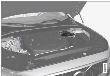
Akumulator pomocniczy 12 V jest umieszczony w skrzynce obok kolumny zawieszenia.
