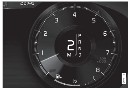
Panoramica dello schema di cambio sul display del conducente per la leva selettore grande.
