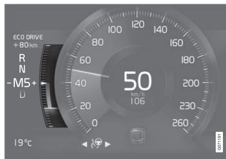
Misuratore ECO sul display del conducente da 8".
