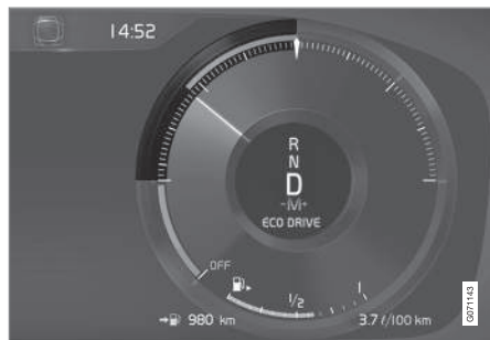
Misuratore ECO sul display del conducente da 12"*.
