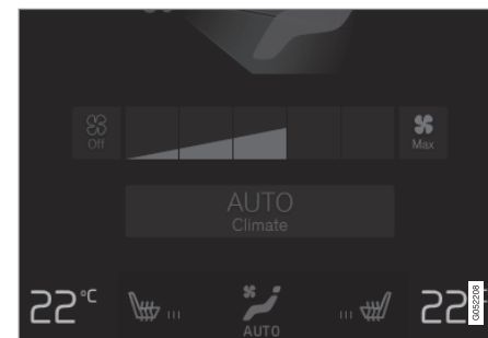
Pulsanti di temperatura nella barra del climatizzatore.
