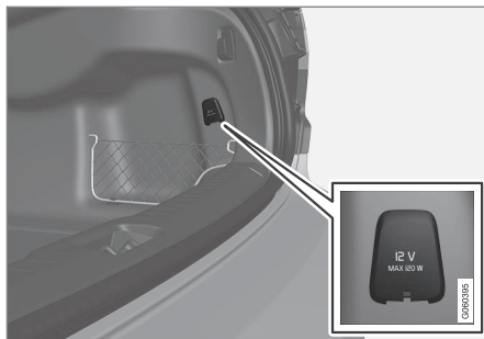
Prise 12 V dans le coffre/compartiment de chargement*.
