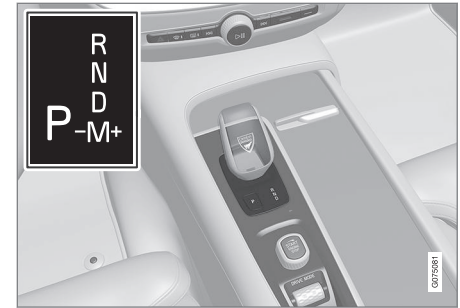
Vue d'ensemble du petit levier de vitesses et de la grille de rapports dans l'écran du conducteur.
