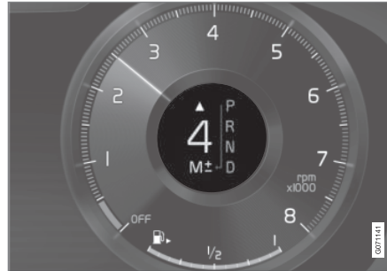
Vaihtamisosoitin 12-tuumaisessa kuljettajan näytössä koskien isoa vaihdevipua*.
