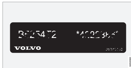
4 Πινακίδα για τον κωδικό κινητήρα και τον σειριακό αριθμό του κινητήρα. Σε ορισμένες εκδόσεις κινητήρων, δεν υπάρχει πινακίδα. Σε αυτές τις περιπτώσεις, ο εγχάρακτος κωδικός κινητήρα αναγράφεται απευθείας πάνω στον κινητήρα.
