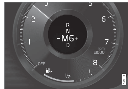
Indikace řazení na 12" displeji řidiče u malé řadič páky*.
