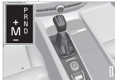
Přehled - velká řadicí páka a schéma řazení na displeji řidiče.
