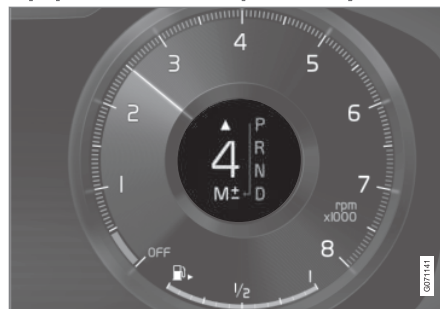
Indikace řazení na 12" displeji řidiče u velké řadič páky*.
