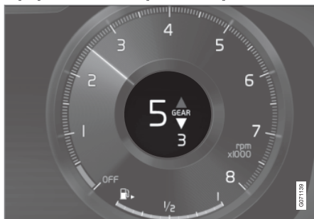
Indikátor řazení převodových stupňů na 12" displeji řidiče*.
