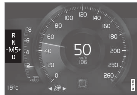
Indikace řazení na 8" displeji řidiče u malé řadič páky.
