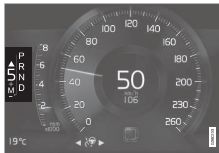
Indikace řazení na 8" displeji řidiče u velké řadič páky.
