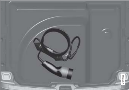
充電電線位於行李廂地板艙板下的儲存空間裡。
