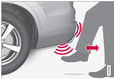
Movimento do pé na zona de ativação do sensor.
