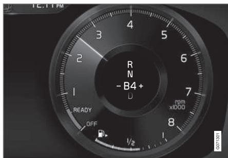
Дисплей на водача при смяна на предавки с лопатките на волана в ръчен режим на превключване на предавки.
