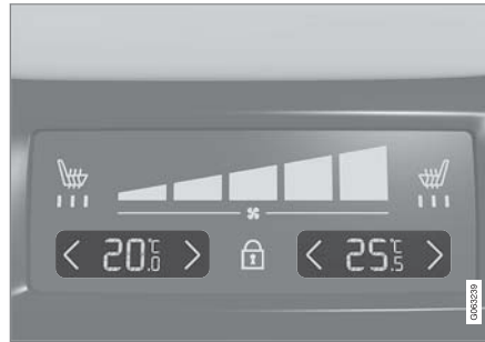
ตัวควบคุมอุณหภูมิตั้งบนส่วนควบคุมสภาพอากาศที่ด้านหลังของคอนโซลบริเวณโพรพหลากลาง
