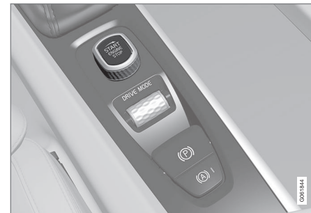
Botão de partida no console de túnel.
