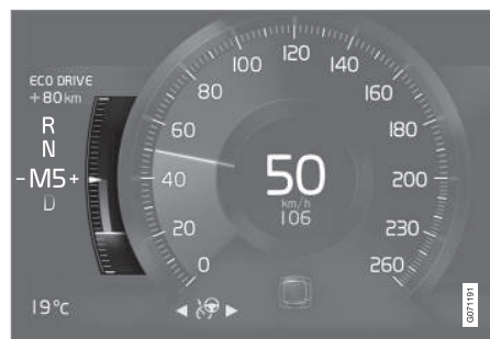
Medidor ECO no visor do motorista de 8 polegadas. O medidor ECO indica em nível de economia da condução:
