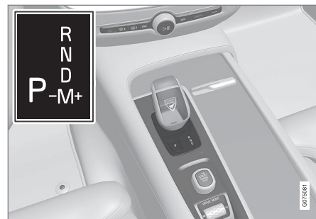
Visão geral da alavanca pequena de marchas e do padrão de mudança de marcha no visor do motorista.
