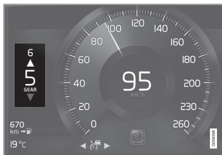
Wskaźnik zmiany biegu na 8-calowym wyświetlaczu kierowcy.
