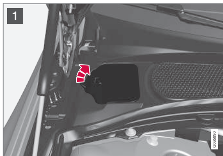
Zbiornik wyrównawczy płynu chłodzącego
