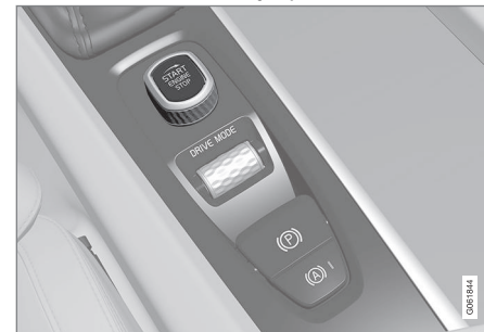
Pokrętko rozruchu na konsoli między fotelami.
