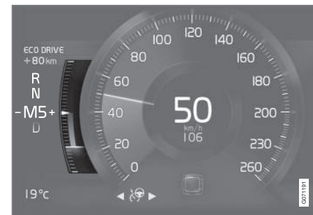
Wskaźnik ECO na 8-calowym wyświetlaczu kierowcy.
