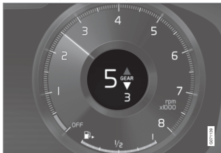
Wskaźnik zmiany biegu na 12-calowym wyświetlaczu kierowcy*.
