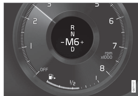
Indicatore cambio di marcia sul display del conducente da 12" per la leva selettore piccola*.
