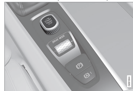
Interruttore di avviamento nel tunnel.
