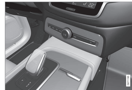
Panoramica della leva del cambio piccola dove non è possibile disattivare l'immobilizzatore della leva selettoria.
