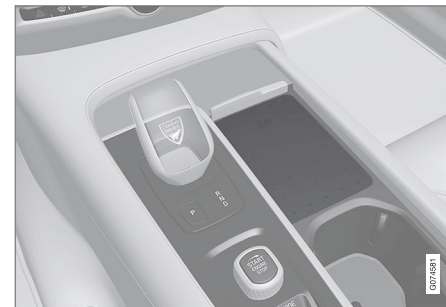
Caricabatterie senza fili per telefono nel tunnel.
