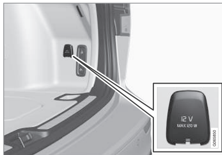
Prise 12 V dans le coffre/compartiment de chargement*.
