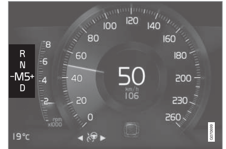
Vaihtamisosoitin 8-tuumaisessa kuljettajan näytössä koskien pientä vaihdevipua.
