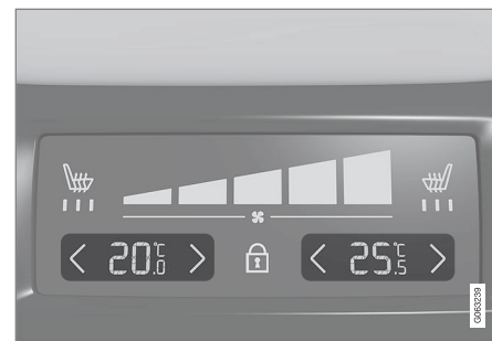
Tunnelkonnoli tagaosa kliimapaneeil olev temperatuuri regulaator.
