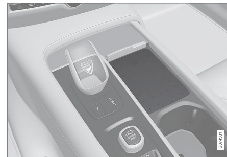
Juhtmeta telefonilaadija tunnelkonsoolis.
