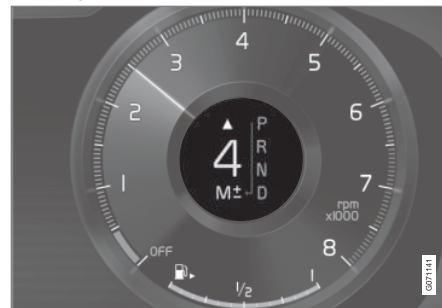
Indicador de cambio de marcha en pantalla del conductor de 12" con palanca de cambios grande*.
