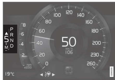
Indicador de cambio de marcha en pantalla del conductor de 8" con palanca de cambios grande.
