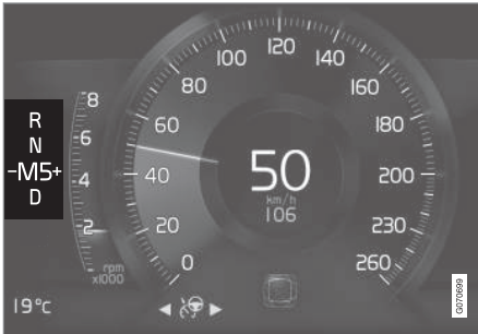
Indicador de cambio de marcha en pantalla del conductor de 8" con palanca de cambios pequeña.
